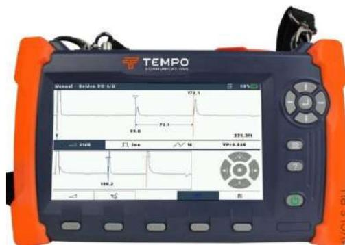
Импульсный рефлектометр Tempo CableScout CS90B
