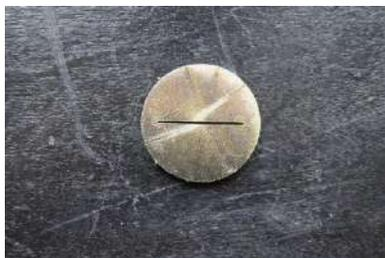
Рис. 2. Диск со сквозной щелью
