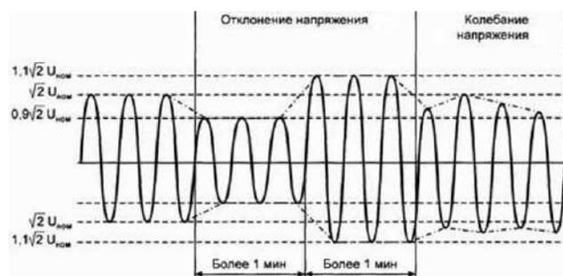
Установившееся отклонение и колебания напряжения
