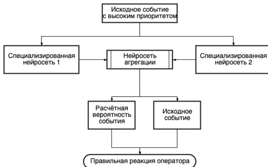
Рис. 1. Алгоритм работы программного обеспечения на базе нейросети для автоматизации средств охраны
