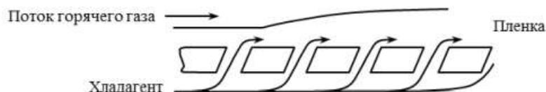
Рис. 4. Схема движения воздушных потоков при эффузивном охлаждении [3]
