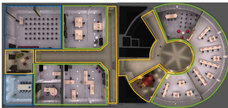
Рис. 2. Организация освещения офисного пространства бизнес-центра: зеленый контур – биодинамическое освещение, желтый – теплый свет 3500 К, синий – холодный свет 6500 К
