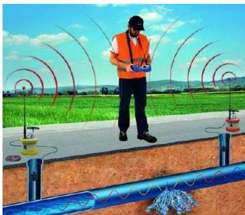
Поиск протечки корреляционным анализом
