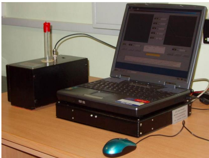
Рис 3. Релаксометр ПМР-NP1 используется для измерения параметров скважинной жидкости
