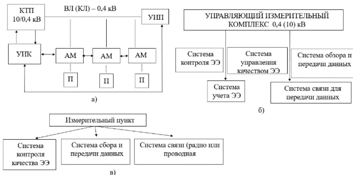
Рис. 2. а) структурная схема управления для устранения несимметричности сети 10/0,4 кВ, АМ (адаптационный модуль управления энергоснабжением потребителя), П (электрическая нагрузка потребителя); б) структурная схема УИК 0,4(10) кВ; в) структурная схема УИП 0,4(10) кВ
