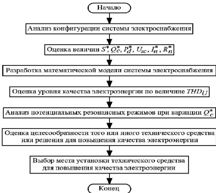
**Рис. 7. Алгоритм анализа и моделирования несинусоидальных режимов для обоснованного выбора технического средства или решения по повышению качества электроэнергии**
