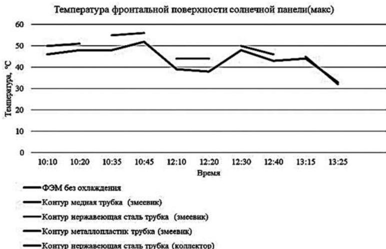
**Рис. 4. График точек максимальной температуры фронтальной поверхности ФЭМ 27.07.23**
