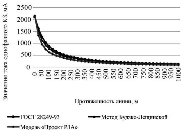
**Рис. 3. Результаты расчетов токов однофазного короткого замыкания в электрической сети 0,4 кВ при использовании трансформатора ТМ-250 и провода А-35**
