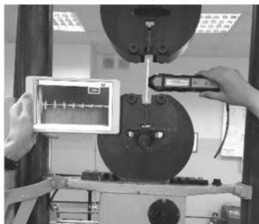
**Рис. 1. Исследование частотных характеристик (АФЧХ) образца стали СтЗсп при растяжении испытательной машиной УММ-5**
