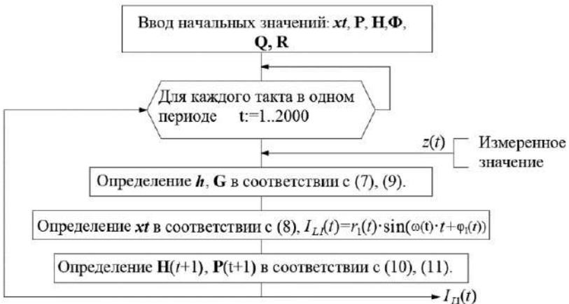
Рис. 4. Блок-схема расширенного фильтра Калмана для управления ГФ
