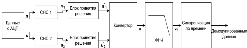
Рис. 3. Структурная схема BPSK демодулятора на основе СНС [3]
