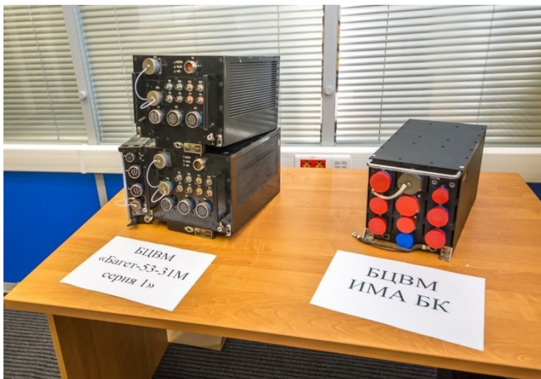
Рис. 4. Старая БЦВМ «Багет» (слева) и новая БЦВМ ИМА БК для Су–57
