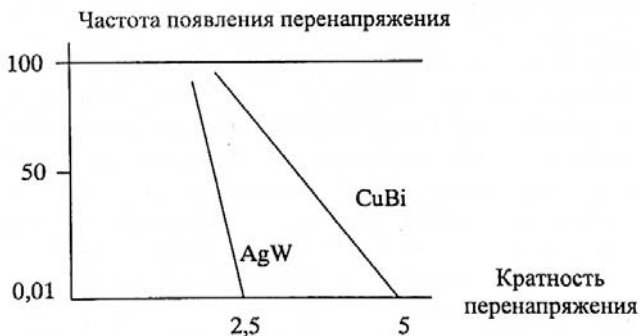
Рис. 1.5. Частота появления перенапряжений при коммутации двигателей вакуумными выключателями с различными материалами контактов
