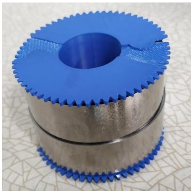
Рис. 2. Сердечник из магнитомягкого аморфного металлического сплава
