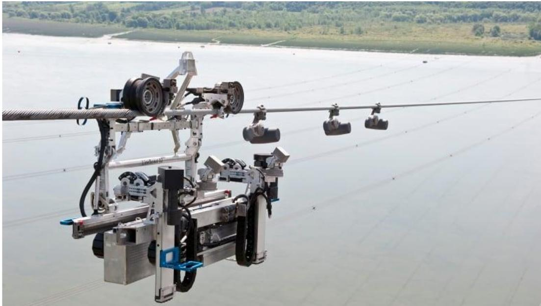
Рис. 1. Робот для обследования ВЛЭП LineScout
