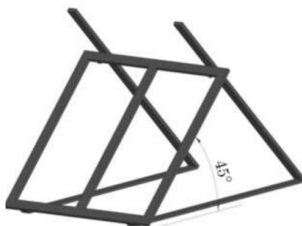
Рис. 3. Схема расположения ФСМ относительно поверхности земли
