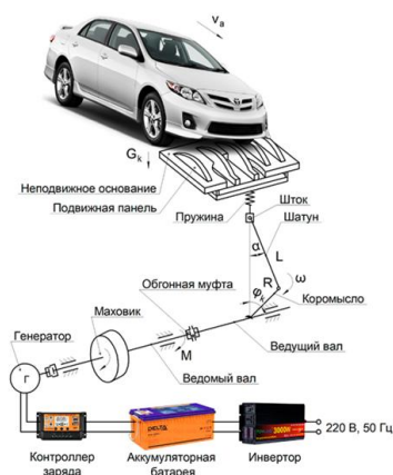
Рис. 1. Дорожная энергетическая установка с ползунно-коромысловым преобразователем
