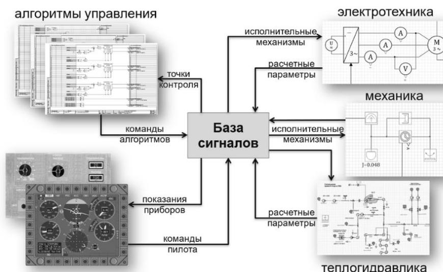
Рис. 1. Концепция построения комплексной модели в *SimInTech*
