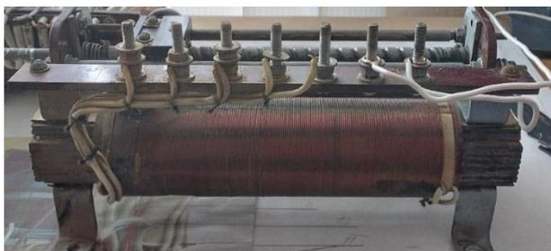
Рис. 9. Регулятор напряжения
