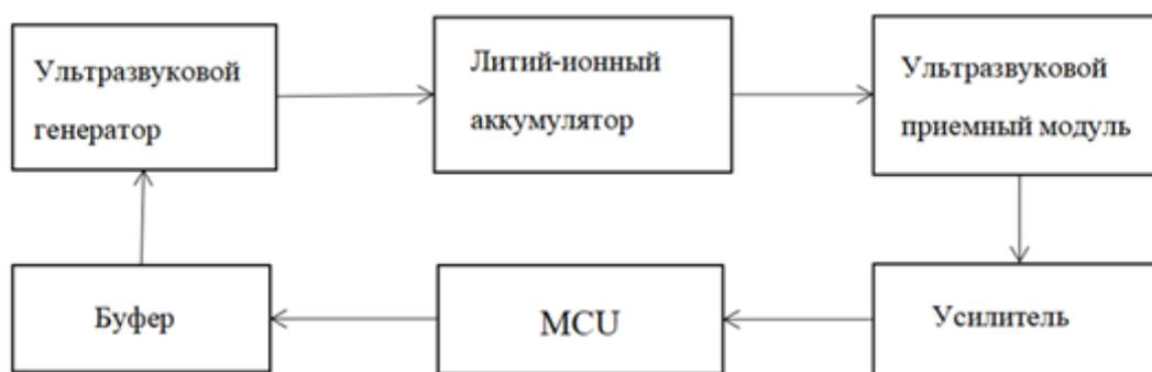
Рис. 1. Схема ультразвукового контроля ЛИАБ
