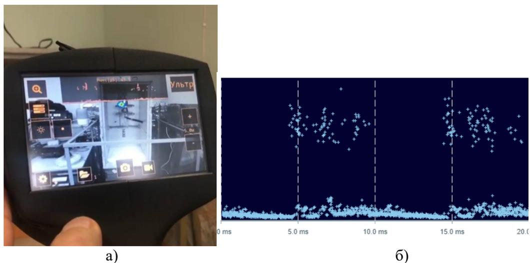
Рис.2. Регистрация дефектов ультразвуковым методом, полученные в лаборатории КГЭУ с помощью NLКамеры. а) фото прибора, б) фото экрана прибора с амплитудно-фазовым распределением
