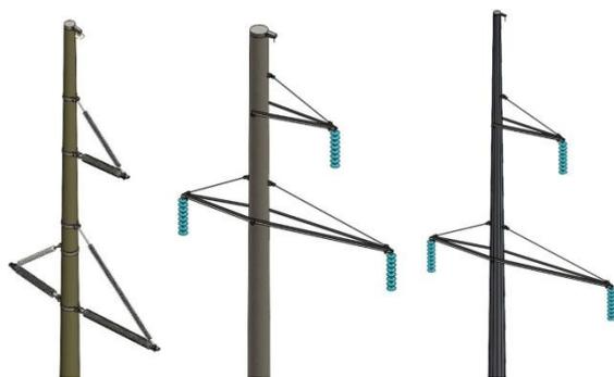
Рис. 1. Геометрические модели опор ПК110-1, ПБ110-1 и ПМ110-1
