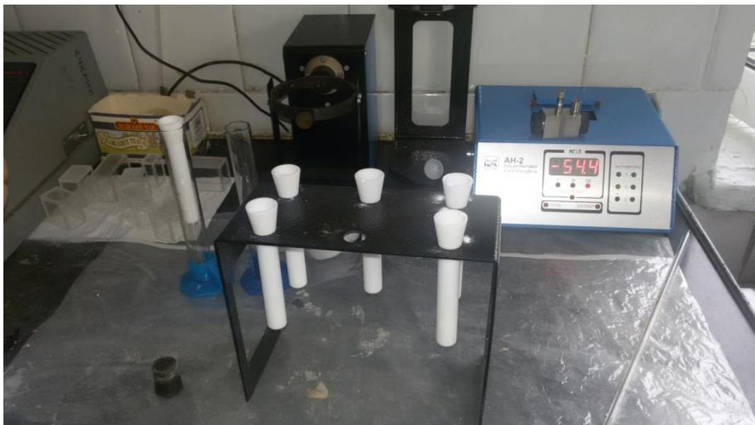
Рисунок 2 –Исследование сточной воды на концентрацию нефтепродуктов
