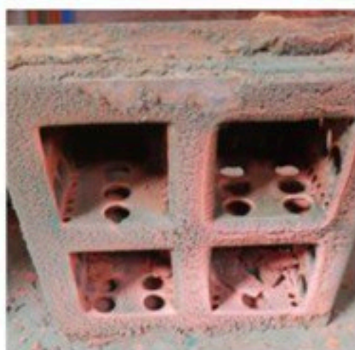
Мультивихревое сепарационное устройство в окрасочно-сушильной камере
