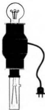
Рис. 1. Прибор для испытания веществ на электропроводность
