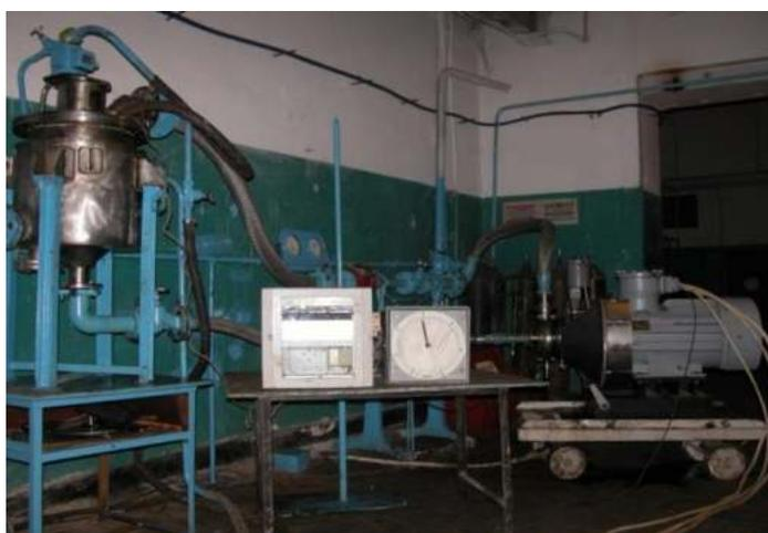
Рис. 2. Общий вид стенда для испытаний роторных теплогенераторов
