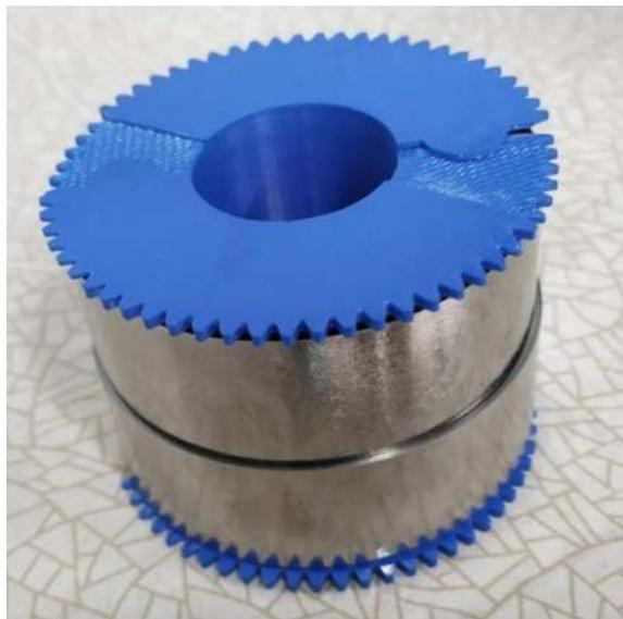
Рис. 2. Сердечник из магнит мягкого аморфного металлического сплава
