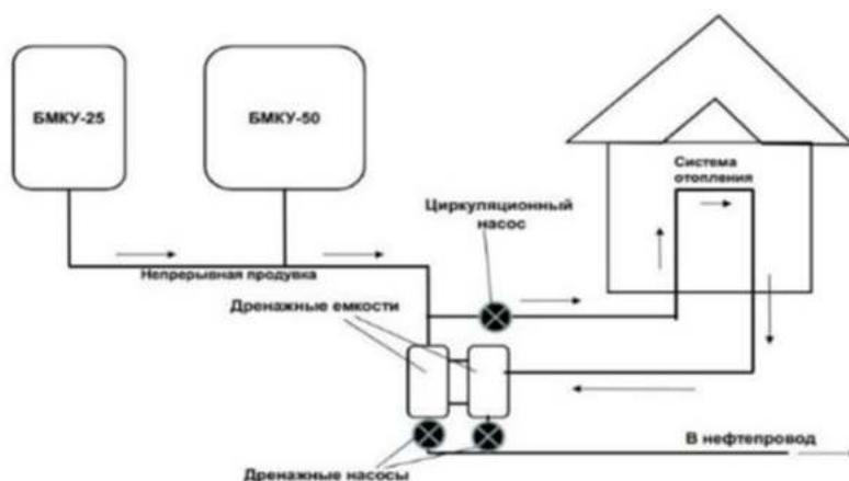
Рис. 1. Система отопления с использованием тепла непрерывной продувки
