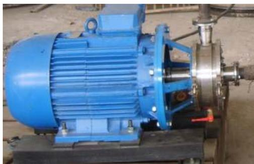
Рис. 3. Общий вид роторного теплогенератора традиционной схемы
