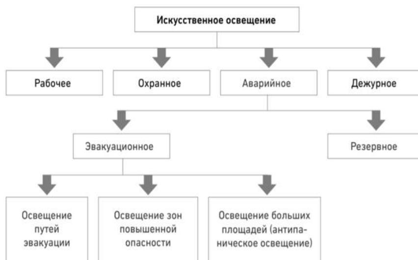
Рис. 1. Классификация аварийного освещения (СП 52.13330.2016)
