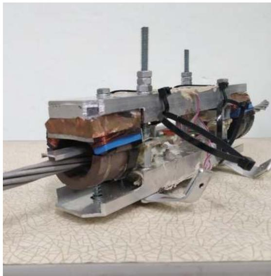
Рис. 1. Датчик состояния ВЛЭП со старой моделью сердечника
