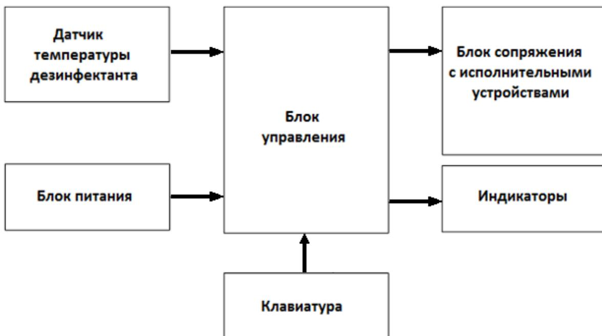
Рис. 4. Структура устройства управления моечной машиной для гибких эндоскопов
