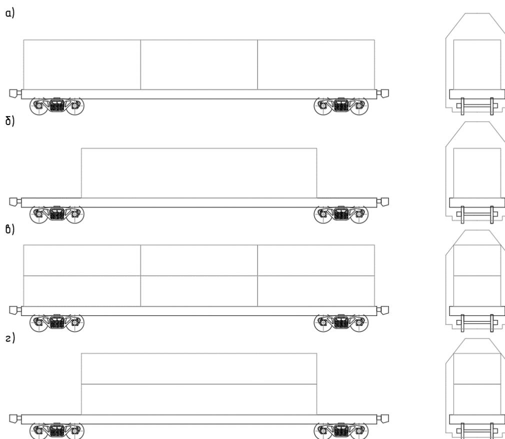
Рисунок 1. Варианты перевозки контейнеров на вагоне-платформе модели 13-9004 в пределах очертания основного габарита погрузки:
