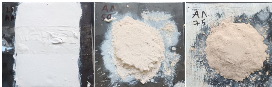
Рис. 2. Образцы теплоизоляционной краски с алкидной основой и добавлением 25, 50, 75% микросфер
