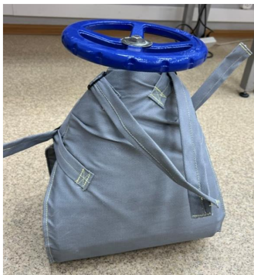
Образец произведённого термочехла с аэрогелевыми композитами в составе
