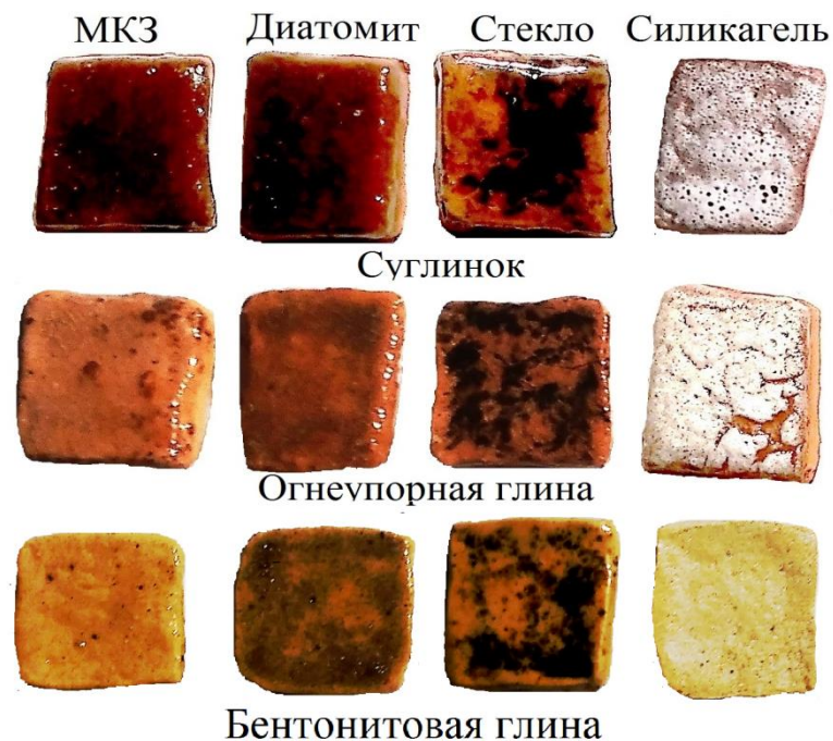
Покрyтия глиняных образцов боросиликатными глазуриями на основе различных видов аморфного кремнезема.
