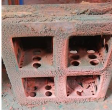
Мультивихревое сепарационное устройство в окрасочно-сушильной камере
