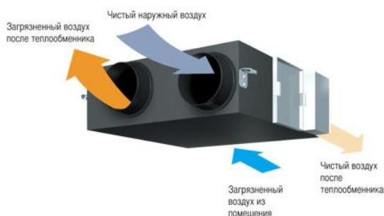
Рис. 3. Камерный рекуператор
