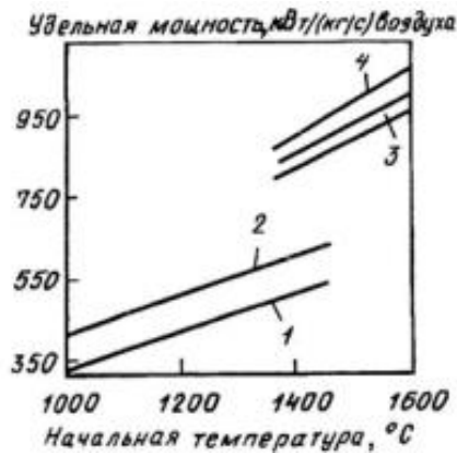
Рис.1. Зависимость удельной мощности парогазовой установки от начальной температуры газа: 1 – парогазовая установка с котлом-утилизатором (одно давление); 2 – парогазовая установка с котлом-утилизатором (два давления); 3 – ISTIG; 4 – ISTIG с паровым приводом компрессора низкого давления.
