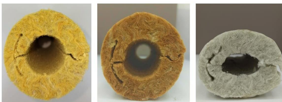
Теплоизоляционные цилиндры BOS плотность 100 кг/м 3 (слева направо): новый образец; после 12 часов при температуре 250 °С (степень конверсии 0,2); после 12 часов при температуре 650 °С (связующее полностью выгорело)
