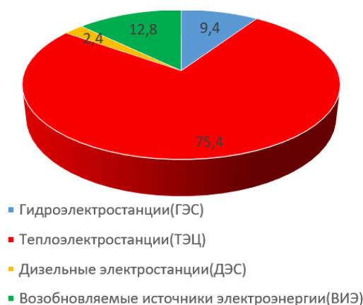
Структура установленной мощности Центрального энергоузла энергосистемы Камчатского края по типам электростанций на 01.01.2022
