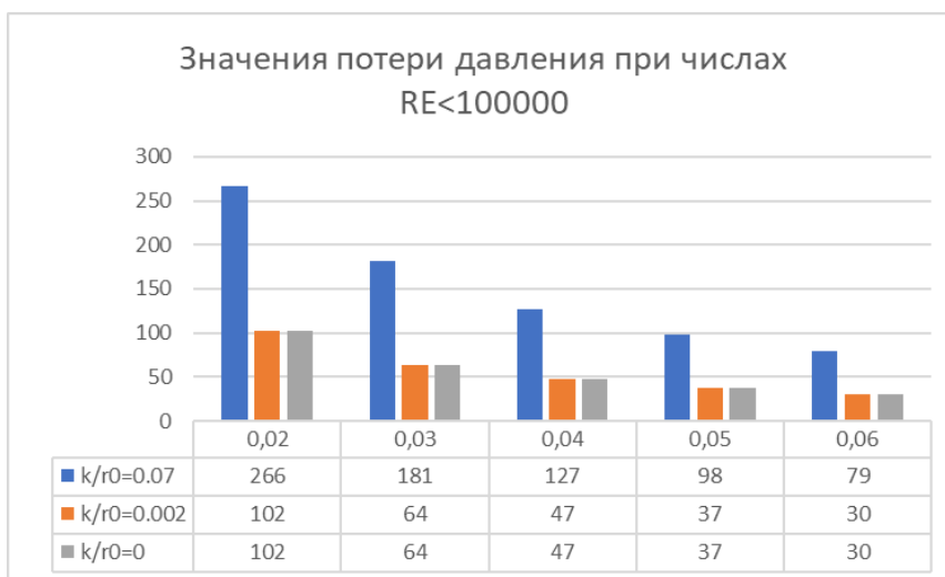
Рис.1. Изменение давление шероховатых трубопроводов разного диаметра при числе Рейнольдса менее 100000
