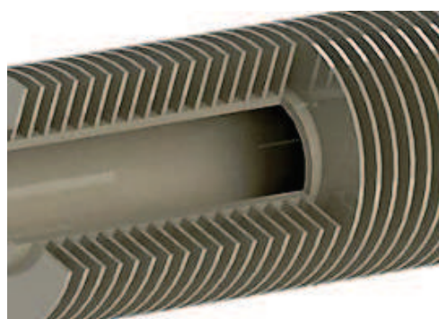
Рис. 1. Трехмерная модель трубы с наружным поперечным оребрением
