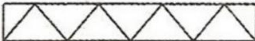
Рисунок 6. Ферма с треугольной системой решетки.
