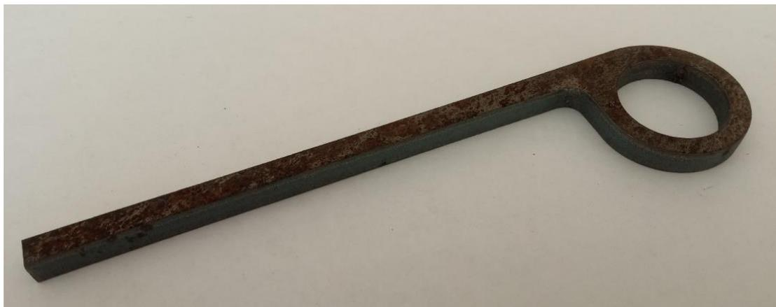
Рисунок 3. Заготовка из стали 40X13.
