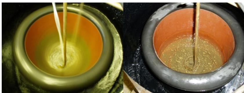
Рисунок 2 – Камера центробежной флотомашины с периферийной разгрузкой концентрата:
