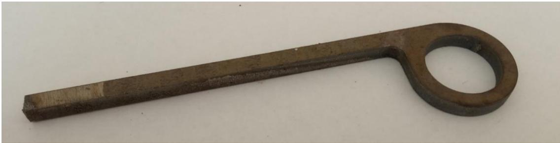
Рисунок 2. Заготовка из стали 20X13.
