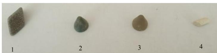
Рисунок 1. Наполнители: 1 – призма скошенная, керамика (ОГЗ); 2 – конус, пластик (СЗ); 3 – конус, пластик (УТЗ); 4 – цилиндр скошенный, фарфор (БМ)
