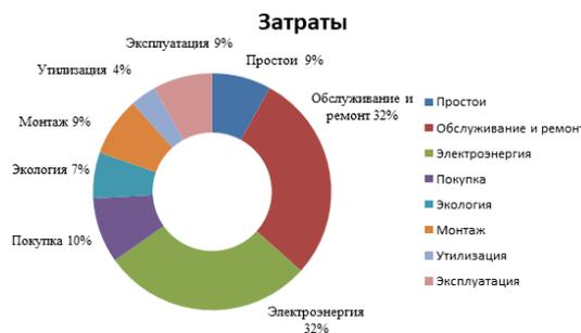
Рисунок 4. Структура эксплуатационных затрат на жизненный цикл насоса
