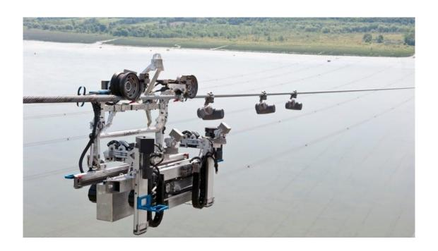
Рис. 1. Робот для обследования ВЛЭП LineScout
