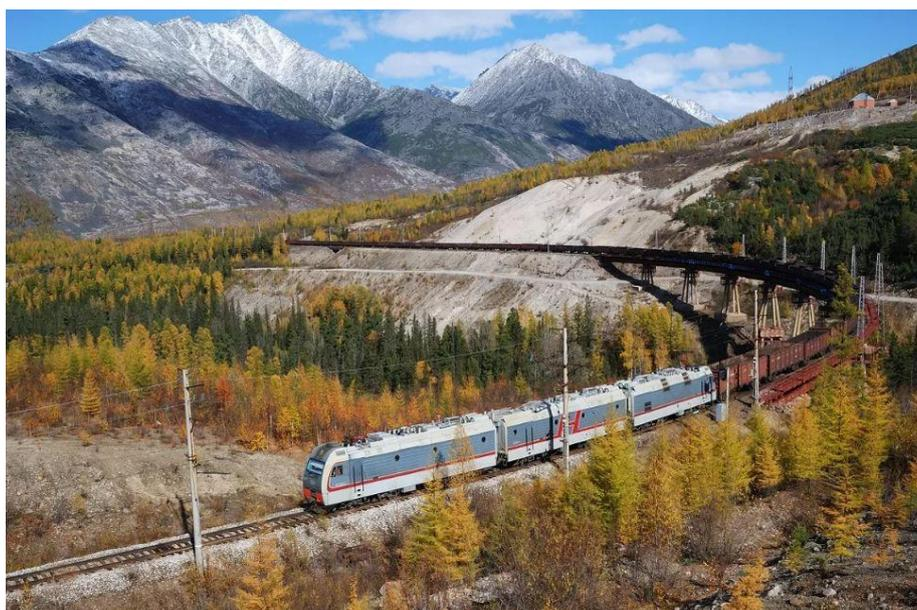
**Рис. 2. Электровоз серии ЗЭС5К с грузовым поездом на БАМе**
