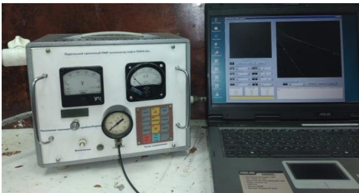
**Рис. 1. Фото комплекса ПМРА-IVп с ноутбуком и графиком разложения огибающей сигналов СЭ в Релаксометре ПМР-NP2 при экспресс-контроле характеристик нефти при мониторинге технологии подготовки нефти**
