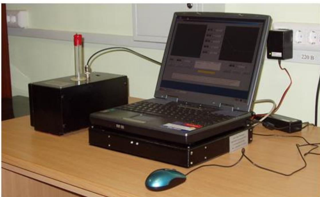
**Рис. 4. Портативный релаксометр ПМР-NP-1**
