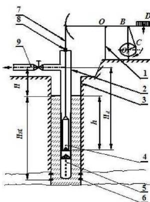
Рисунок 1. Принципиальная схема штанговой глубинно-насосной установки.
