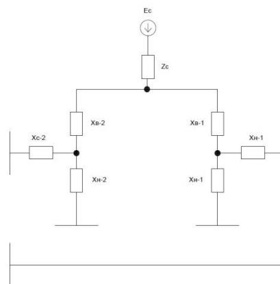
Рисунок 2. Схема замещения прямой последовательности для расчета ТКЗ в точках К1, К2 и К3.
