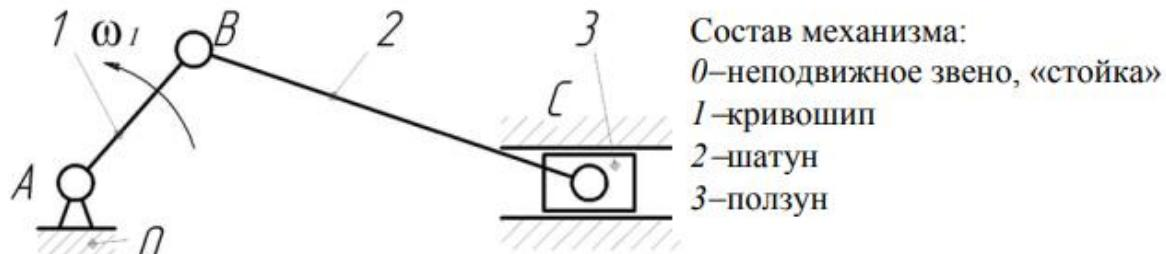
Рисунок 1. Кинематическая схема четырехзвенного кривошипно-ползунного механизма.
