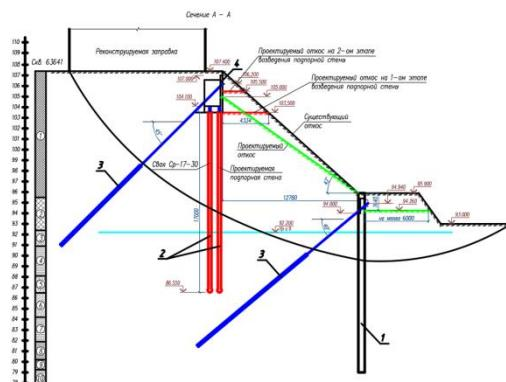
Рис. 2 Поперечное сечение прислоненного откоса с противооползневыми заглубленными железобетонными конструкциями: 1 - существующая подпорная стена из буронабивных свай диаметром 500,0 мм; 2 - буроинъекционные сваи ЭРТ усиления основания в два ряда; 3 - грунтовые анкера ЭРТ усиления склона; 4 - монолитная уголковая же-лезобетонная подпорная стена.
