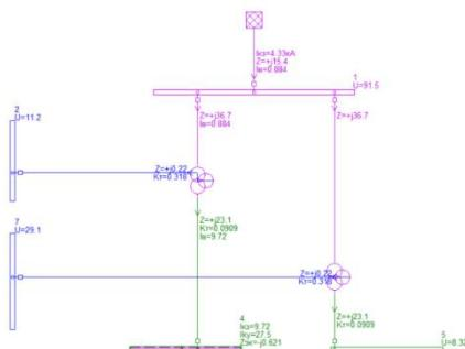
Рисунок 5. Короткое замыкание на шине низшего напряжения трансформатора Т2.
