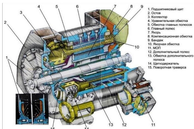
Рисунок 1 – Тяговый электродвигатель коллекторного типа и его устройство
