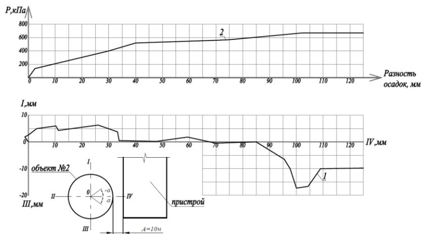
Рисунок 5. Объект №2. График нарастания неравномерной осадки I с ростом среднего давления 2 на основание
