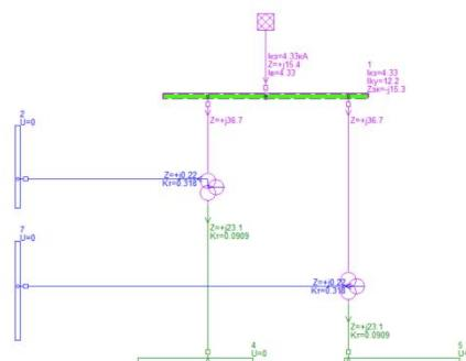
Рисунок 3. Короткое замыкание на шине системы.
