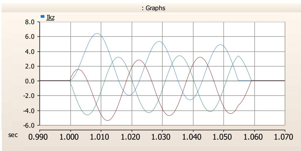
Рисунок 4. Осциллографма трехфазного короткого замыкания в ПС PSCAD.
