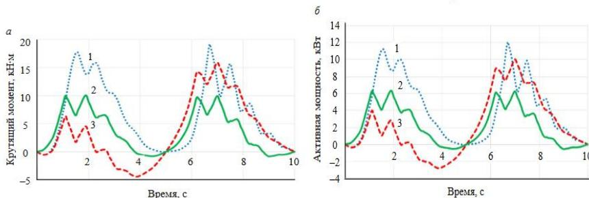
Рисунок 6. Крутящий момент на кривошипном валу (а)
