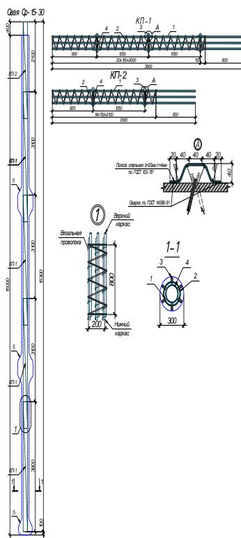
*Рисунок 1. Пример схемы армирования буроинъекционной сваи-ЭРТ Cp-15-30 (15 – длина сваи в м., 30 – диаметр в см.). 1 - продольная арматура класса A500с; 2 – поперечная арматура класса A240; 3 – фиксатор каркаса сваи (из стальной пластины b=20мм, t=4мм; 4 - труба d159мм обеспечивает жесткость каркаса при транспортировке и складировании; 5 – уширения вдоль ствола и пяты сваи.*
