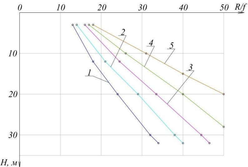
Рисунок 1 Графики зависимости  $R/f = f(h)$  при различных значениях показателя текучести  $IL$
