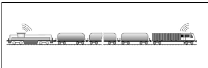
Рисунок 1. Двухтактный поезд.
