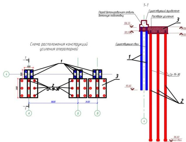
Рисунок 4 Схема усиления основания фундаментов операторной: 1 - существующие забивные сваи; 2 - буроинъекционные сваи ЭРТ; 3 - подводимая монолитная же-лебетонные консольные балки под существующие железобетонные рострники.
