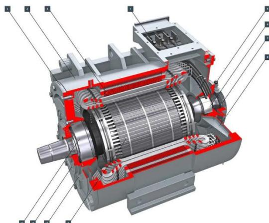
Рисунок 2. Тяговый электродвигатель асинхронного типа и его устройство
