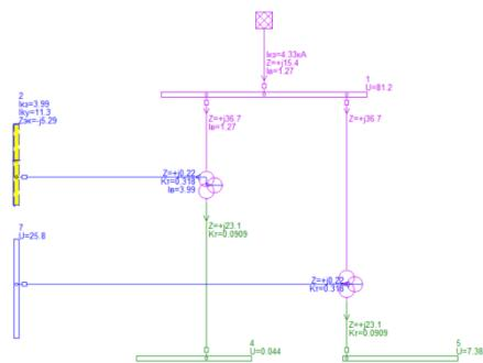
Рисунок 4. Короткое замыкание на шине среднего напряжения трансформатора Т2.
