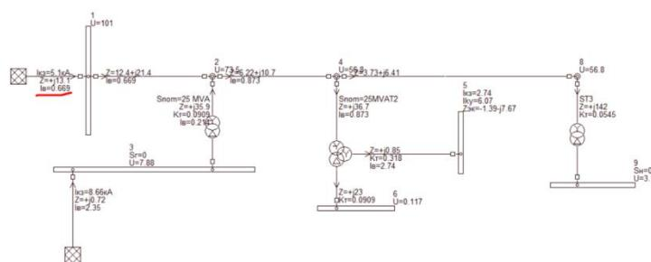
Рисунок 6. Проверка сходимости расчетов в ПК EnergyCS TK3.
