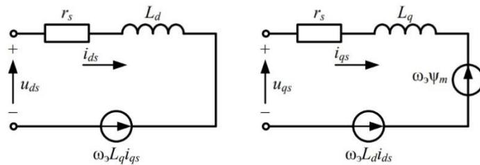
Рисунок 3. Схема замещения СДПМ в осях dq
