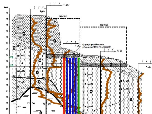
**Рисунок 1 Инженерно-геологический разрез с привязкой буроинъекционных свай.**
