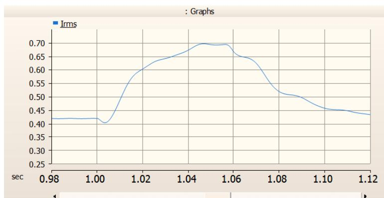
Рисунок 4. График изменения начального периодического действующего значения трехфазного ТКЗ в ПС PSCAD.
