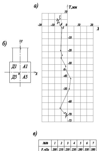
Рисунок 11. Объект №5. а - график изменения величины и направления неравномерной осадки; б – схема разбивки фундамента на квадраты; в – таблица роста среднего давления на основание
