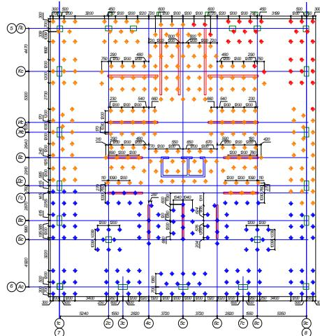
Рисунок 3 Свайное поле из буроинъекционных свай ЭРТ
