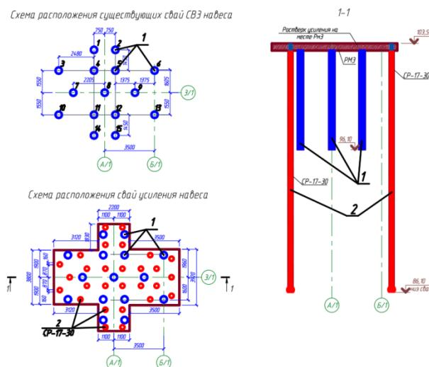
Рис. 5 Схема усиления основания фундаментов навеса: 1 - существующие забивные сваи; 2 - буроинъекционные сваи ЭРТ.
