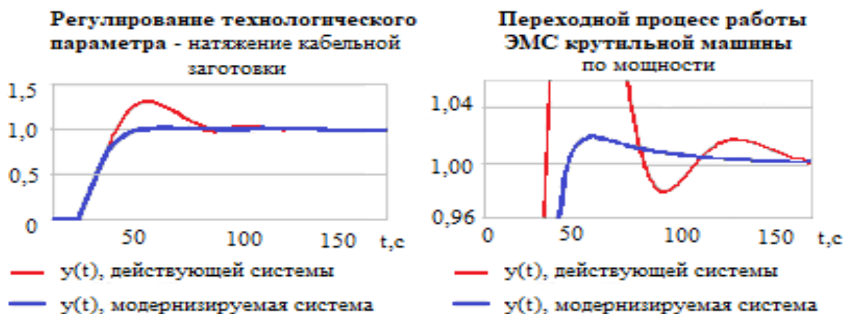
Рис. 5 – Результаты моделирования переходного процесса в действующей и модернизируемой системе: y(t) – выходной параметр системы.
