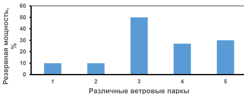
Рис. 3 – Резерв для балансирования мощности в энергосистеме Азербайджана в случаях установки каждой отдельной ВЭС (Баку, Мараза, Ленкоран) и их сочетаний 1 – Ленкоран; 2 – Мараза; 3 – Баку; 4 – Баку+Мараза; 5 – Баку+Мараза+Ленкоран.
