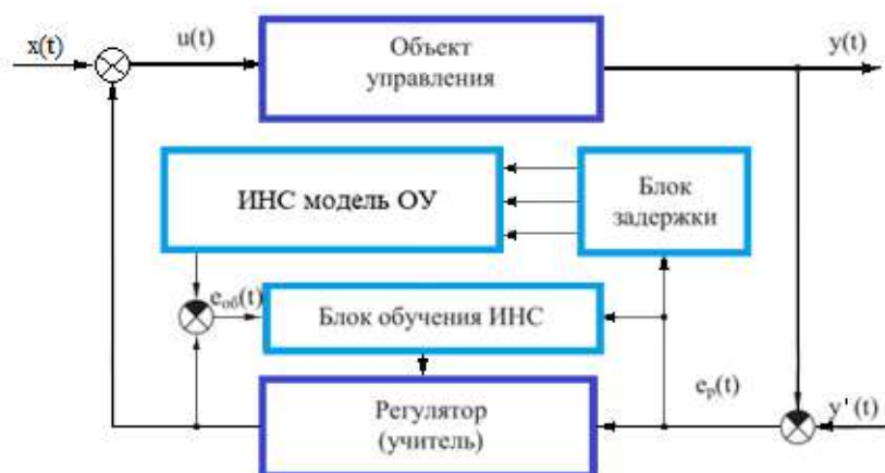
Рис. 1 – Блок-схема обобщенного варианта ИНС: x(t) - входной сигнал; e_{ob}(t) - ошибка обучения, представляющая собой разницу между значением на выходе и регулирующими воздействиями u(t) ; y(t) - выходное воздействие объекта.
