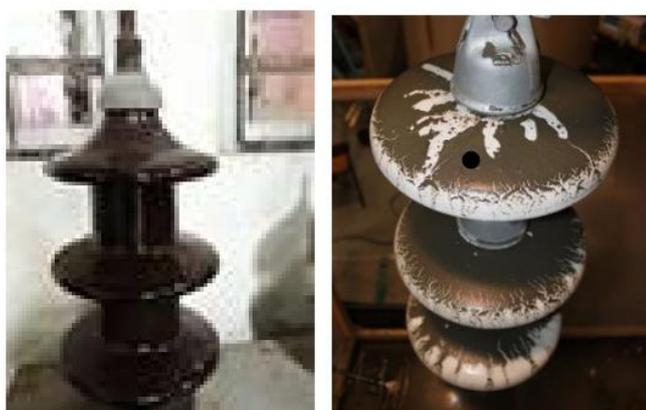
Рис. 2. Рабочий (слева) и дефектный (справа) изоляторы
