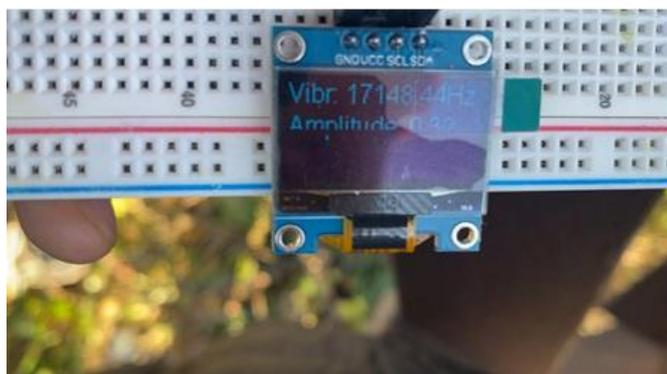
Рис.2. Пиковое значение вибрации опоры ВЛ 220 кВ
