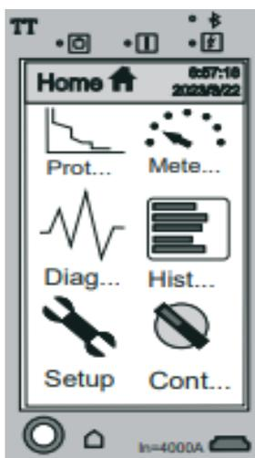
Рис.2. Домашняя страница дисплея выключателя *IEK ARMAT*
