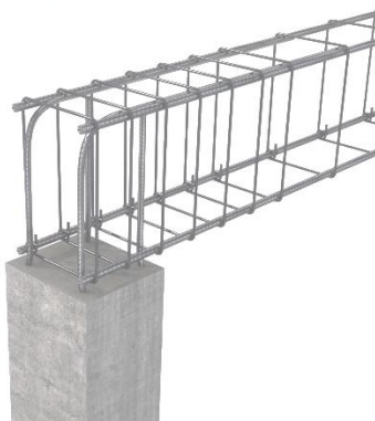
Рис. 1. Модель узла сопряжения монолитных железобетонных колонны и ригеля
