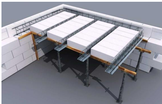
Рис. 3. Перекрытия из пенобетонных блоков
