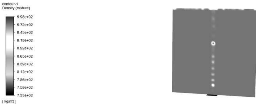
Рис. 1. Результаты расчёта модели куба, заполненного водой с тепловыделяющей пластиной на дне
