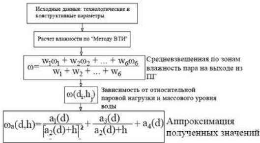
Рис. 1. Блок-схема разработки ДСХ ПГВ-1000
