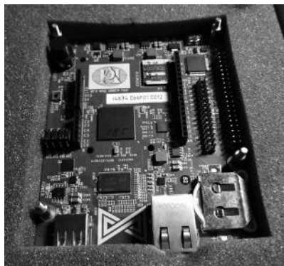
Рис. 1. Программируемый логический контроллер на отечественной элементной базе
