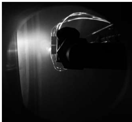
Рис. 1. Фотография макета в плазме в режиме интенсивного дугообразования
