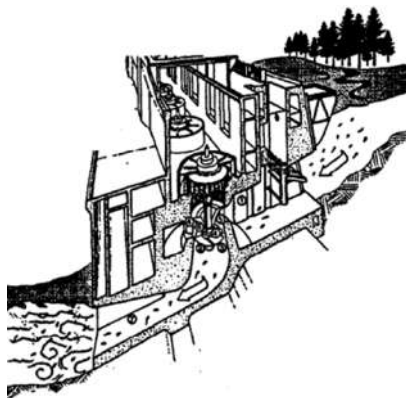
Рис. 1. Течение водяного потока через гидротурбину
