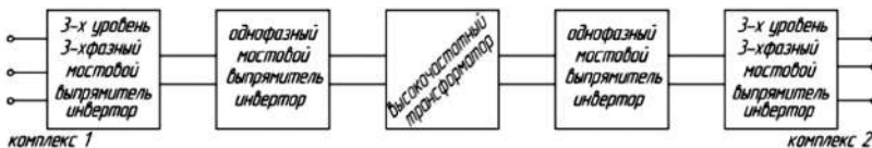
Рис. 2. Структурная схема энерго роутера на напряжение 6(10) кВ
