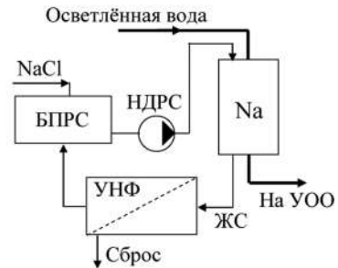
Рис. 1. Технологическая схема утилизации жёсткого стока и получения из него регенерационного раствора: БПРС — бак подготовки регенерационного раствора поваренной соли; НДРС — насос-дозатор раствора соли
