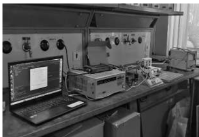
Рис. 1. Аппаратно-программный комплекс измерения параметров резонаторов
