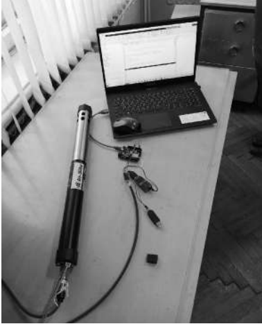
Рис. 1. Система интернета вещей для мониторинга водных объектов
