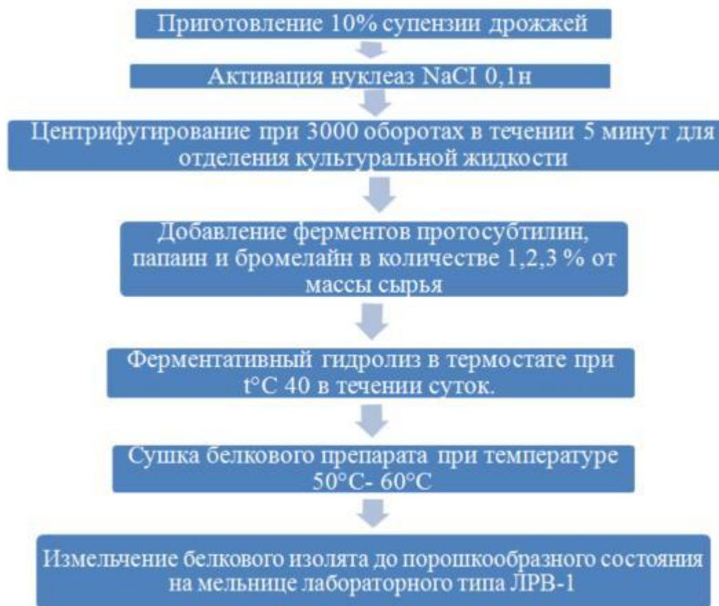
Рис. 1. Получение микробного белка на основе дрожжевых грибов Saccharomyces cerevisiae
