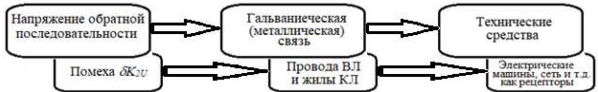
Рисунок 2 – Физико-логическая схема возникновения, распространения в сети одного класса напряжения и воздействия \delta K_{2U} на технические средства как рецепторы
