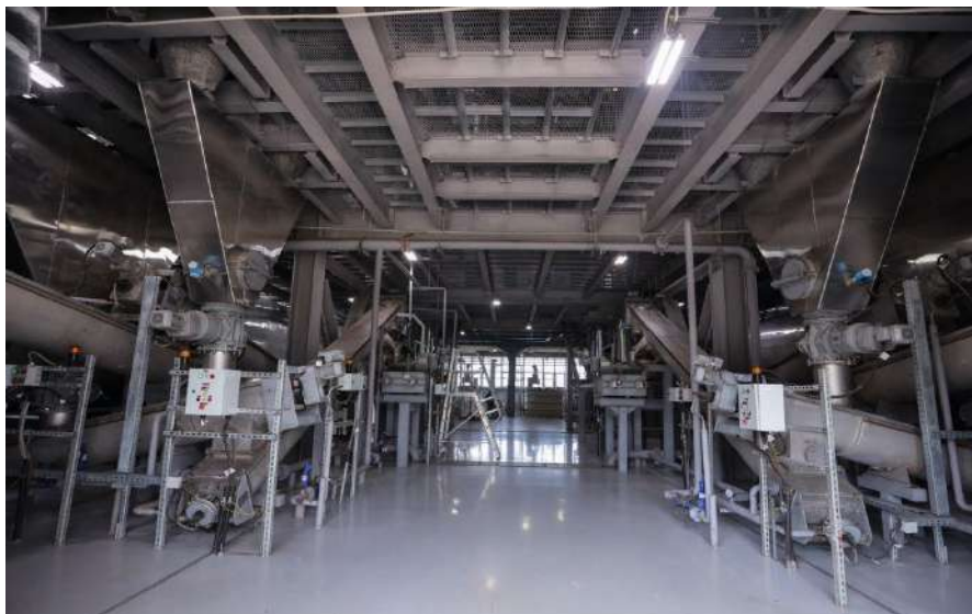
Рис. 1. Линия термомеханической обработки илового осадка
