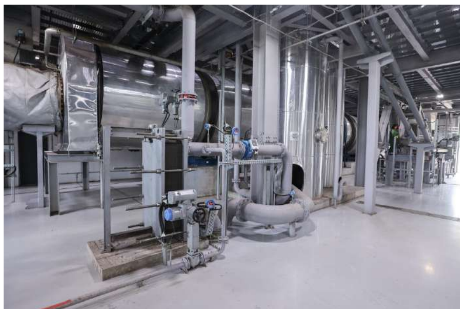
Рис. 2. Сушильный барабан линии термомеханической обработки илового осадка
