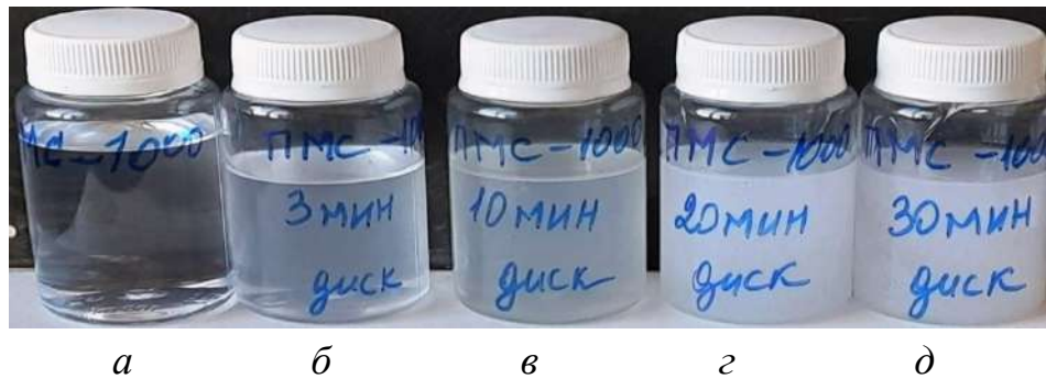
Рис. 1. Внешний вид жидкости ПМС-Ж 10 000 исходной (а) и после МО, мин: б – 3; в – 10; з – 20; д – 30
