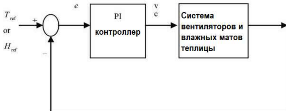
Рис. 1. Блок-схема системы управления теплицей с использованием ПИ-регулятора
