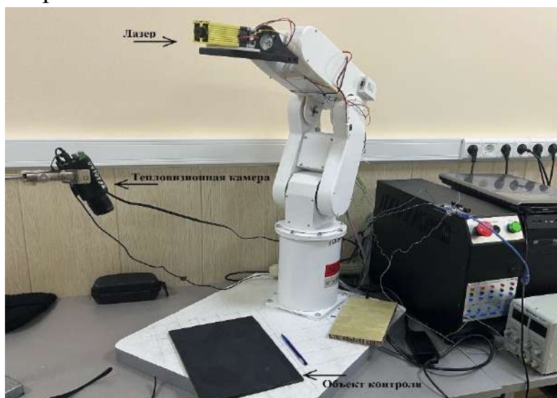
Рис. 1. Установка для динамической точечной лазерной термографии
