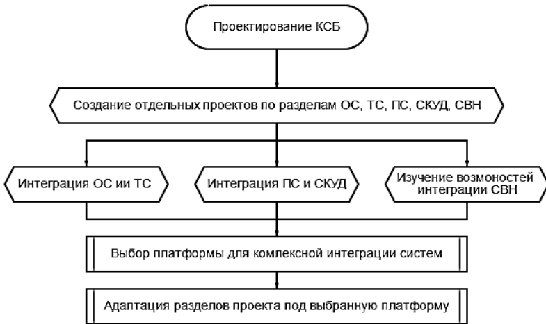
Рис. 1. Алгоритм проектирования комплексной системы безопасности
