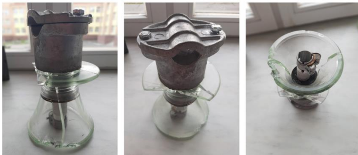
Рис. 3. Внешний вид поврежденного изолятора ШТИЗ 10Б
