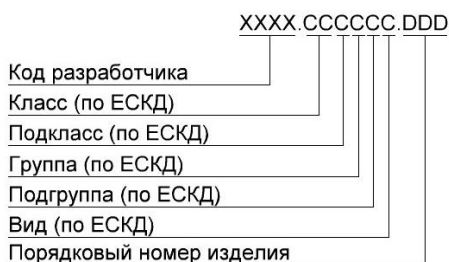
Рис. 1. Расшифровка обозначения изделия обезличенным способом по ГОСТ Р 2.201-202X
