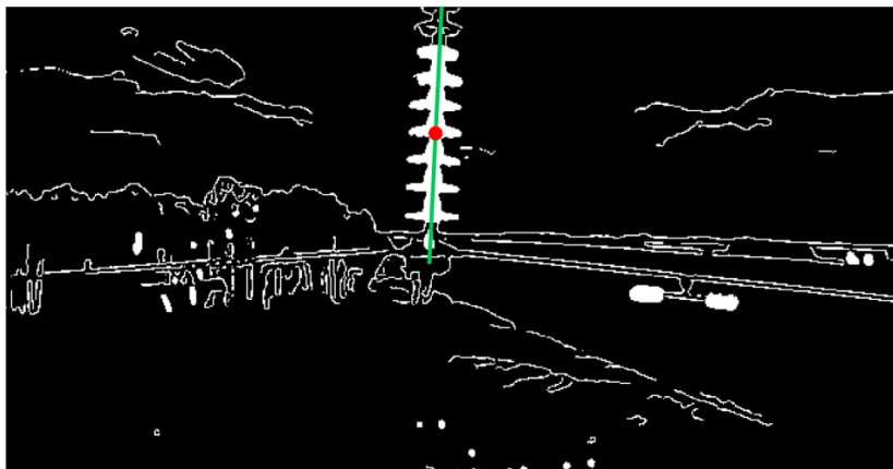
Рис. 3. Графическая интерпретация результатов работы подпрограммы выделения изоляторов на изображении
