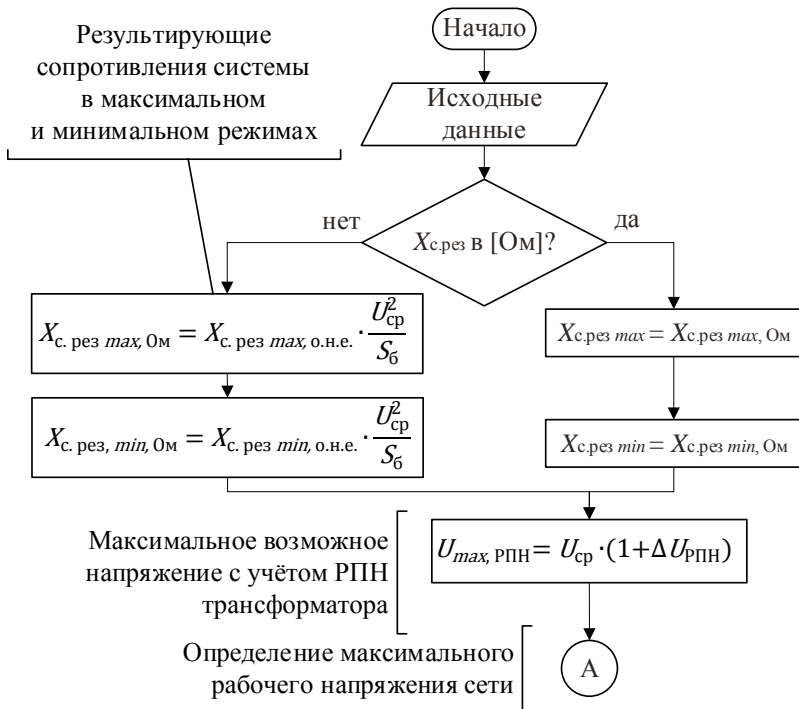
Рис. 1. Блок-схема алгоритма расчёта результирующих сопротивлений и максимального возможного напряжения
