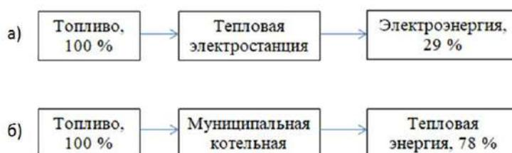
Рисунок 1. Раздельное производство электроэнергии и тепла
