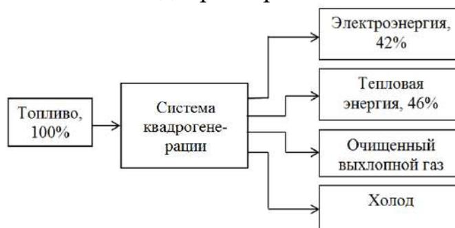
Рисунок 4. Совместное производство электроэнергии, тепловой энергии, холода и углекислого газа
