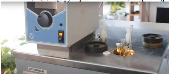
Рис. 1 Положение вискозиметра в термостате
