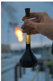
Рис. 2 Пикнометр, заполненный нефтепродуктом
