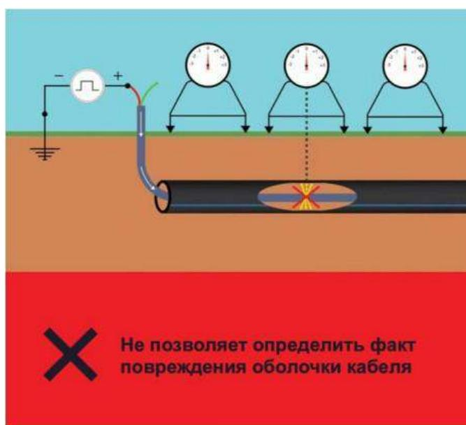
Рис. 2. Испытания кабеля в обычной трубе [3]
