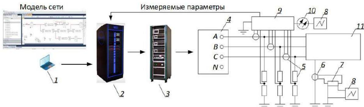
Рис. 1. Структурная схема испытательной установки с ПАК RTDS и усилителями PONOVO: 1 – компьютер с моделью сети; 2 – ПАК RTDS; 3 – усилители PONOVO PAV3000; 4 – трехфазный повышающий трансформатор; 5 – датчики тока и напряжения ЦТТН; 6 – трансформатор тока; 7 – измерительный шунт; 8 – цифровой запоминающий осциллограф; 9 – электронный блок ЦТТН; 10 – оптоволоконный канал связи; 11 – электромагнитный ТН
