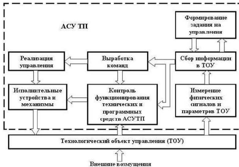
Рис. 1. Структурная схема АСУ ТП
