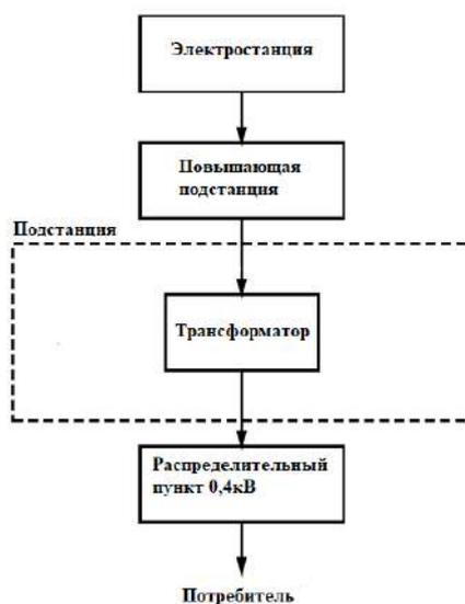
Рис. 1. Схема традиционной энергосистемы
