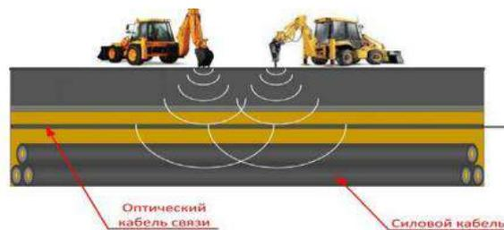
Рис.2. Схема расположения КЛ и оптического кабеля связи
