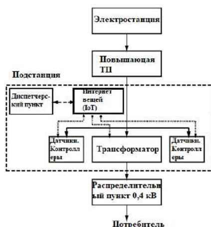
Рис. 2. Схема интеллектуальной трансформаторной подстанции.
