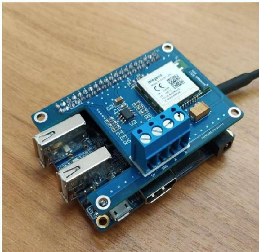
Рис. 1. Опытный образец модуля преобразования данных
