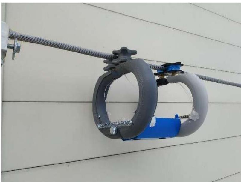
Рис. 1. Экспериментальный образец роботизированного комплекса для мониторинга ВЛЭП
