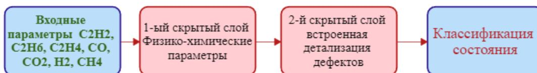
Рис. 2 Топология нейронной сети для классификации дефектов
