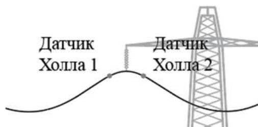
Рисунок 2 – Модель детектирования обрыва провода
