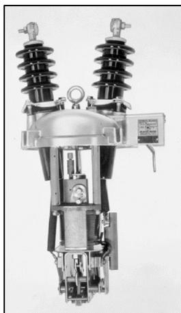
**Рисунок 2. Однофазный реклоузер, извлеченный из масляного бака. Показанный реклоузер имеет максимальное номинальное напряжение 14,4 кВ и номинальный ток отключения 1250 А [1]**
