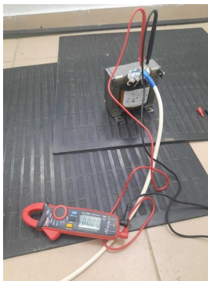
Рис.3. Проверка ОСО-0,25 УХЛ 3 на наличие неисправностей
