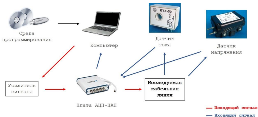
Рис. 3. Структурная схема прибора снятия амплитудно-частотной характеристики кабельной линии.
