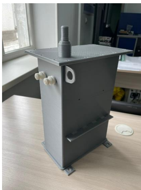
Рис.2. 3D-модель трансформатора ОМП 10/10/0,23
