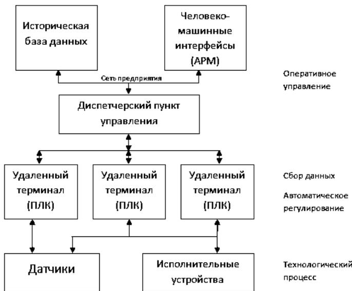
Рисунок 1 – Характерная конфигурация SCADA
