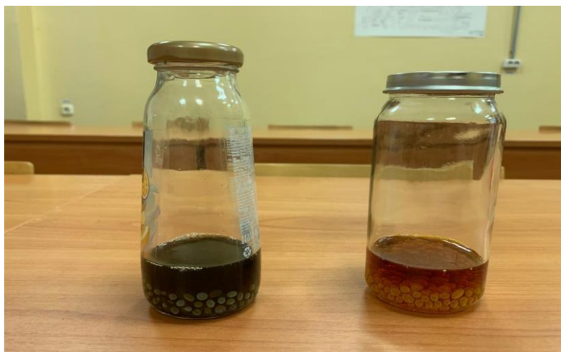
Рис. 3 Пробы масла с силикагелем; слева - №4 проба масла, полученная лабораторным методом, справа - №5 проба масла, отработавшее на заводе
