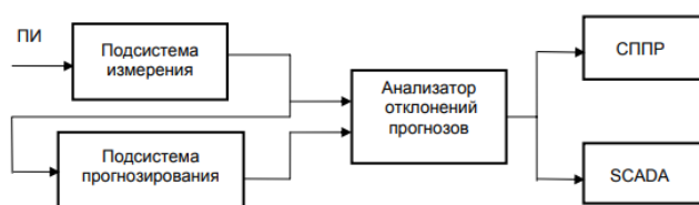
Рис. 2. Структура АСКУЭ с функцией прогнозирования потребления ЭЭ [5]
