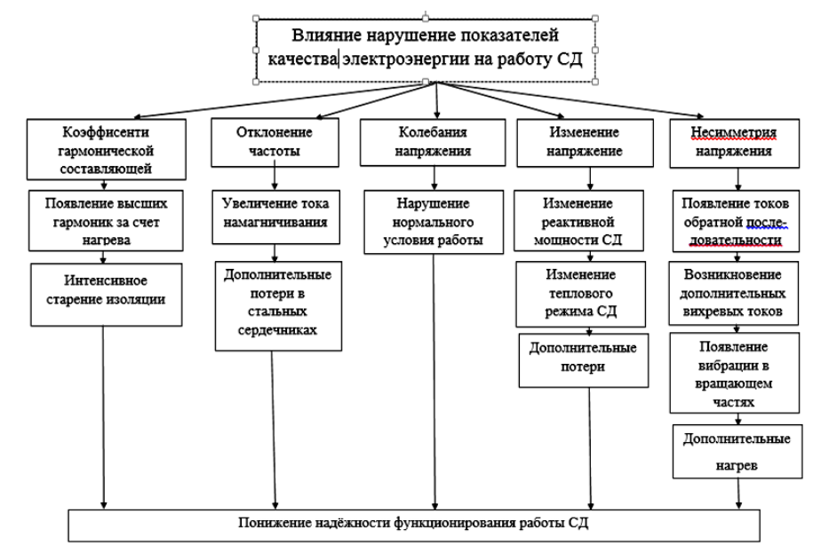
Рис. 2 - Влияние нарушение показателей качества электроэнергии на работу СД.
