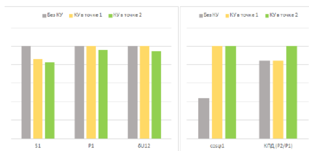
Рис. 5. Сравнение результатов без применения погружного УКРМ, с применением погружного УКРМ в начале цепи (точка 1), с применением погружного УКРМ в непосредственной близости
