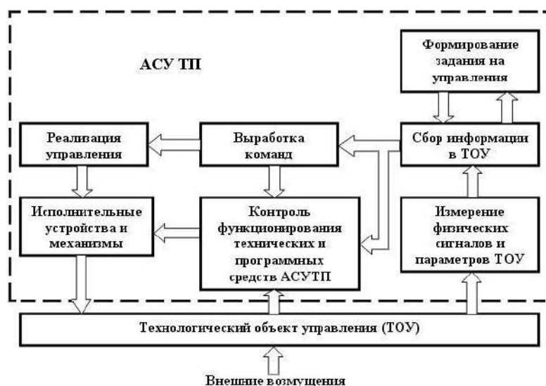
Рис. 1. Структурная схема АСУ ТП
