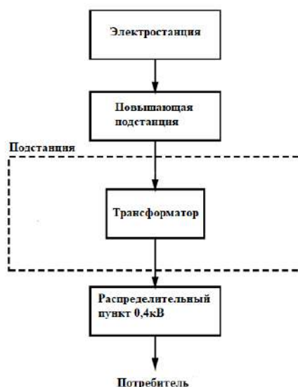
Рис. 1. Схема традиционной энергосистемы
