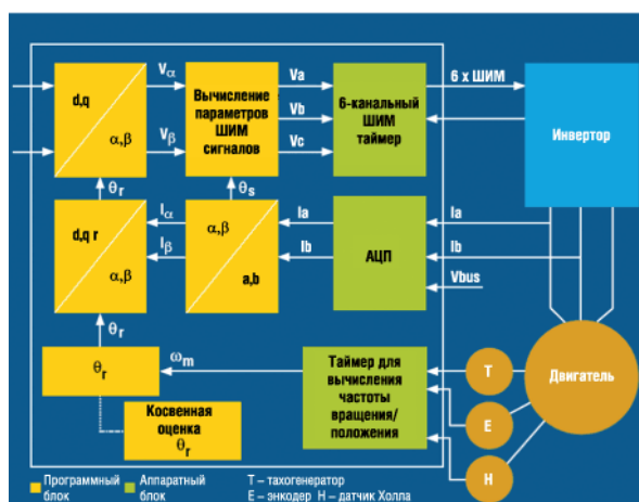
Функциональная схема устройства векторного управления электродвигателем на основе МК STM32
