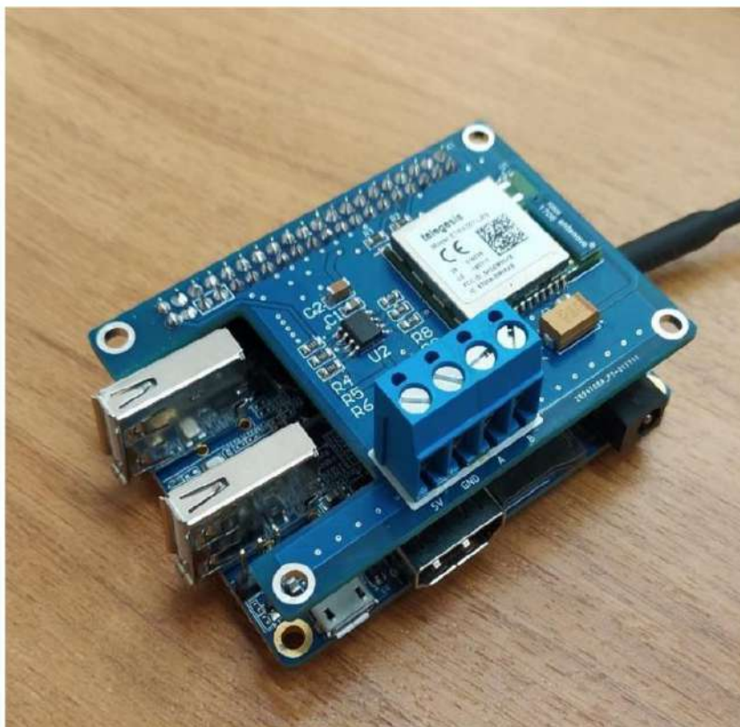
Рис. 1. Опытный образец модуля преобразования данных
