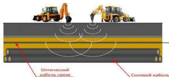
Рис.2. Схема расположения КЛ и оптического кабеля связи
