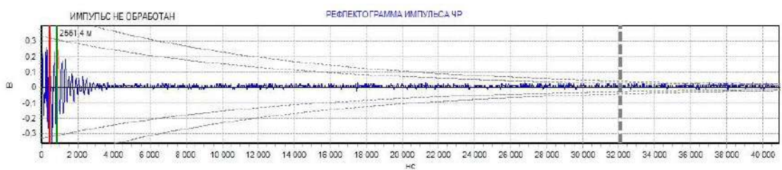
Рис. 1. Рефлектограмма первого силового кабеля
