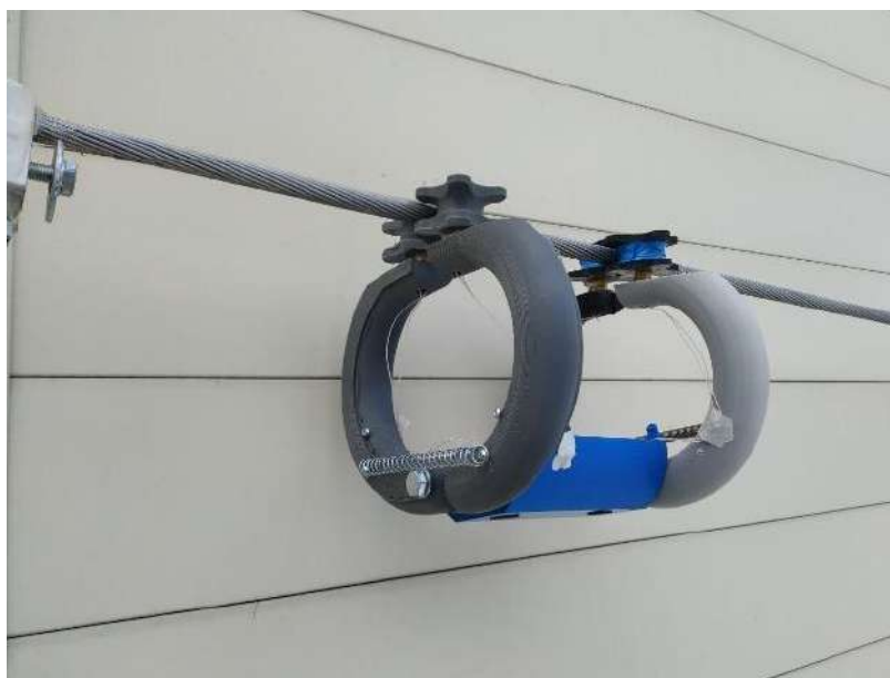
Рис. 1. Экспериментальный образец роботизированного комплекса для мониторинга ВЛЭП
