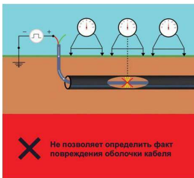
Рис. 2. Испытания кабеля в обычной трубе [3]
