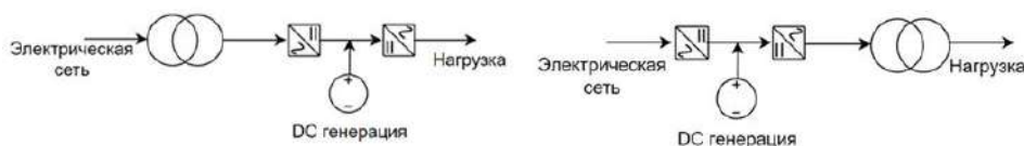
Рис.2. Варианты топологии микросети с разрывом в сети переменного тока
