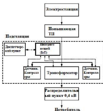
Рис. 2. Схема интеллектуальной трансформаторной подстанции.
