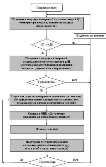
Блок-схема алгоритма работы комплексной системы мониторинга [2]
