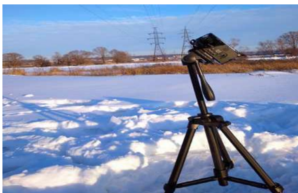
Рис.1. Видеокамера записывает провода линии передачи при разных температурах окружающей среды
