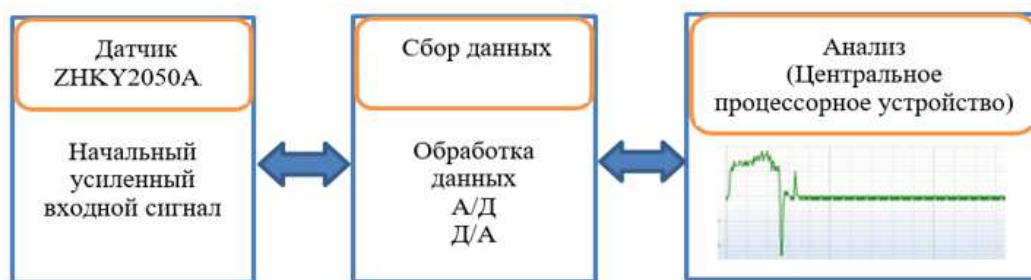
Структурно-функциональная схема устройства измерения крутящего момента
