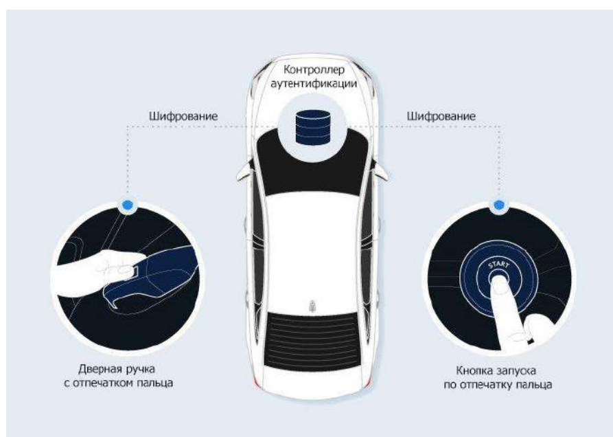
Рис.1. Система аутентификации автомобиля по отпечатку пальца
