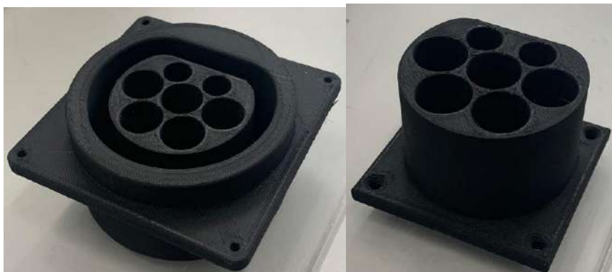
Рис.3. Упрощенная и полноценная модель штекерного разъема
