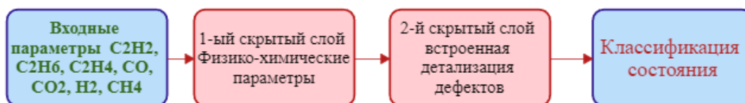
Рис. 2 Топология нейронной сети для классификации дефектов
