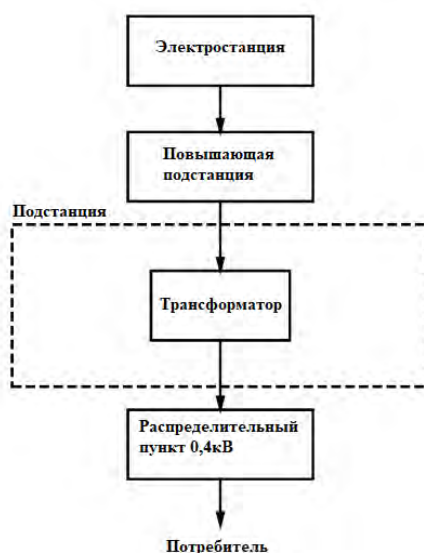
Рис. 1. Схема традиционной энергосистемы
