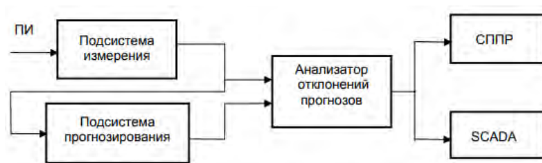
Рис. 2. Структура АСКУЭ с функцией прогнозирования потребления ЭЭ [2]
