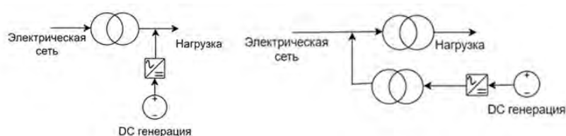
Рис.1. Топологии микросети с частичной и полной гальванической развязкой по переменному току
