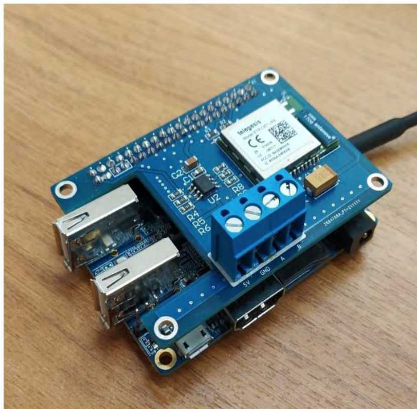
Рис. 1. Опытный образец модуля преобразования данных
