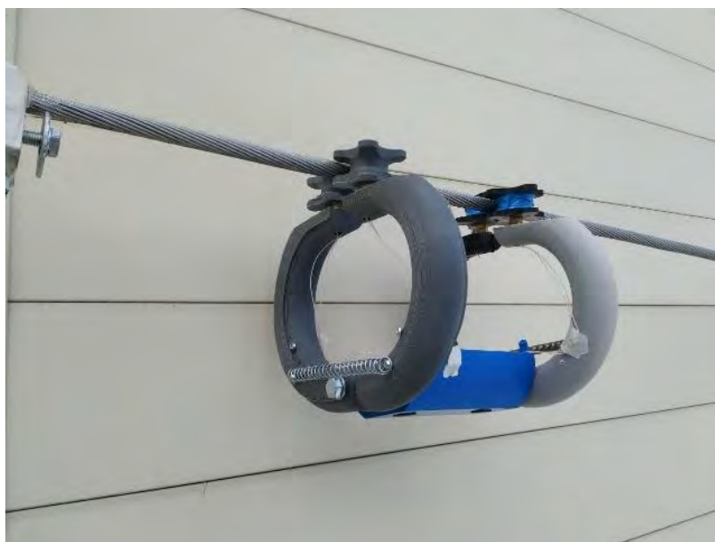
Рис. 1. Экспериментальный образец роботизированного комплекса для мониторинга ВЛЭП
