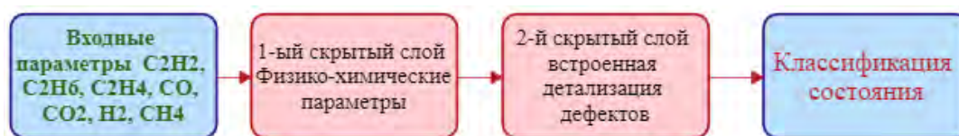
Рис. 2 Топология нейронной сети для классификации дефектов
