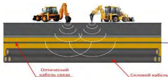
Рис.2. Схема расположения КЛ и оптического кабеля связи
