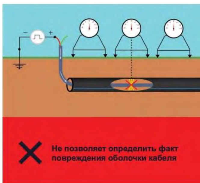
Рис. 2. Испытания кабеля в обычной трубе [3]
