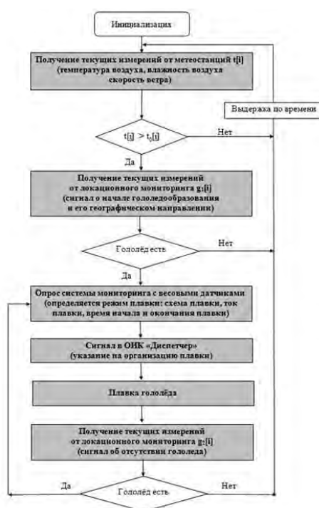
Блок-схема алгоритма работы комплексной системы мониторинга [2]
