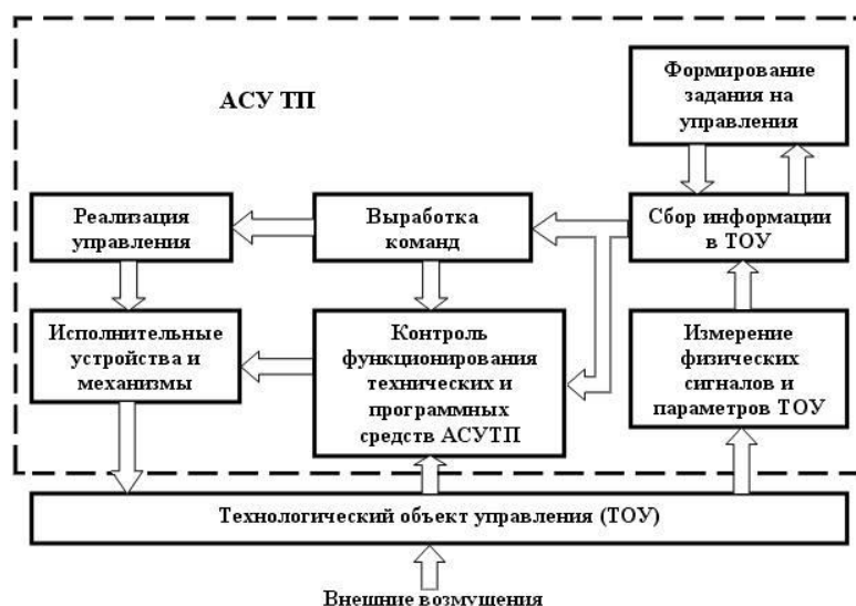
Рис. 1. Структурная схема АСУ ТП
