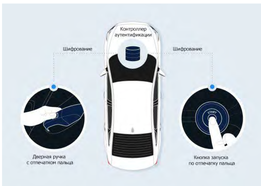
Рис.1. Система аутентификации автомобиля по отпечатку пальца
