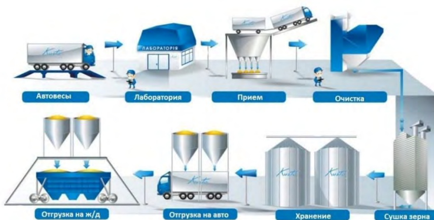
Рис. 1. Технологический процесс обработки зерна
