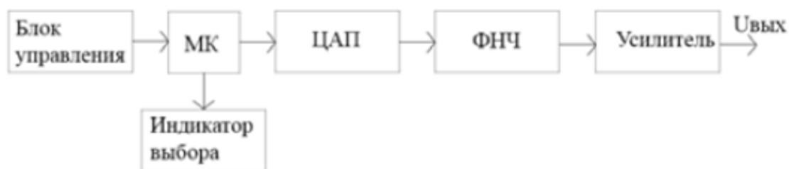
Рис. 1. Структурная схема генератора сигналов
