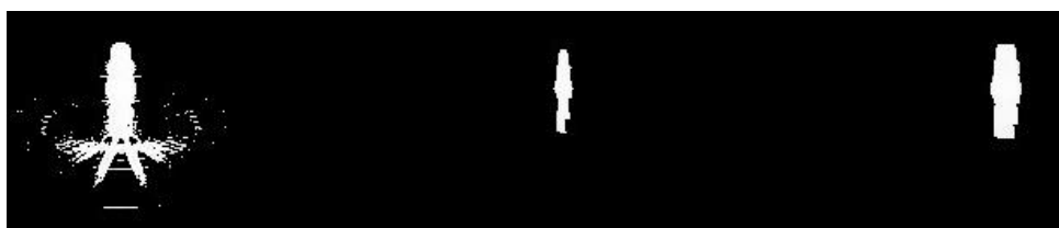
Рис. 2. Исходное бинарное изображение, применение эрозии, применение эрозии и дилатации с одним структурным элементом
