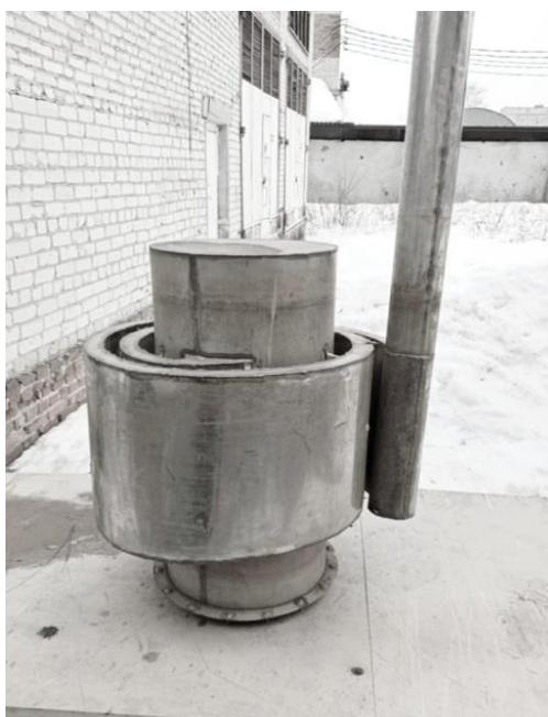
Рис. 2. Общий вид спиралевидного теплообменника
