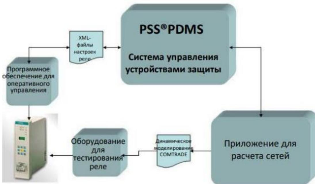
Рис. 1. Схема передачи данных об устройствах защиты
