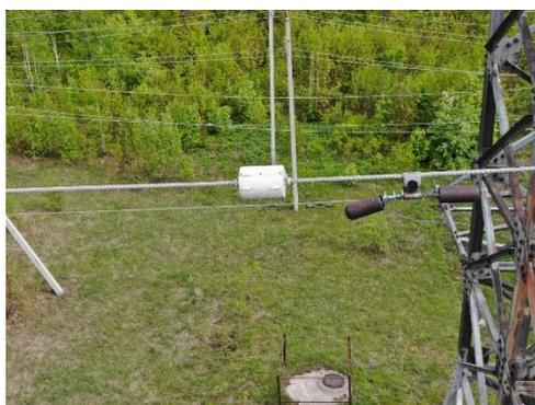
Рис. 2. Новая версия датчик состояния ВЛЭП
