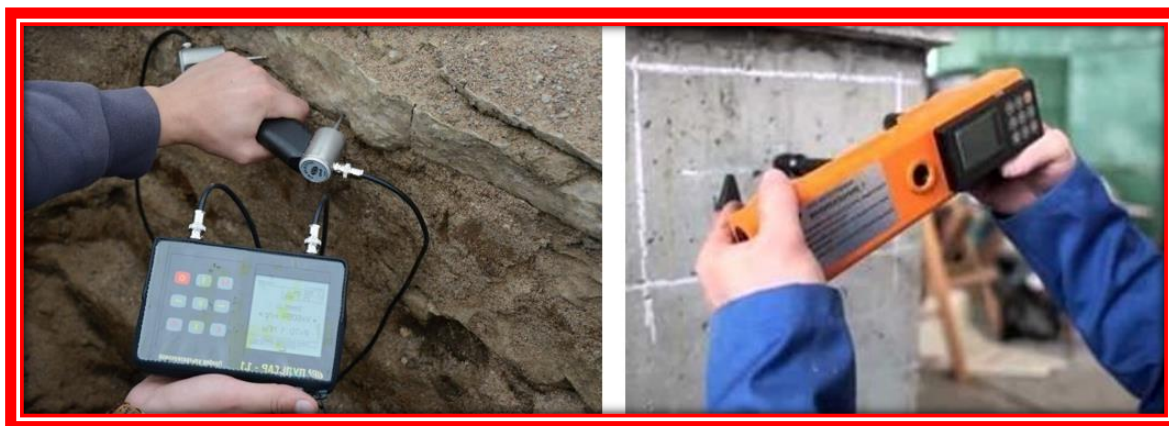
Рисунок 1 – Определение прочности бетона неразрушающими методами: а – ультразвуковым прибором для контроля прочности ПУЛЬСАР; б – методом отрыва со скалыванием прибором ОНИКС-ОС
