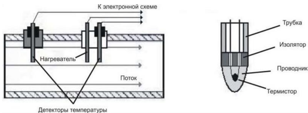
Рисунок 1 – Принципиальная схема термоанемометрического расходомера
