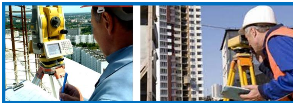
Рисунок 2 – Выполнение геодезических наблюдений за осадками здания: а – с использованием электронного тахеометра, б – с использованием электронного нивелира
