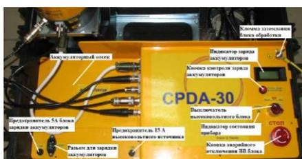
Рис. 1. Конструкция прибора CPDA-30
