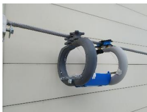
Рис. 1. Экспериментальный образец роботизированного комплекса для мониторинга ВЛЭП
