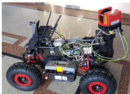
Рис. 1. Беспилотный квадроцикл для осмотра ВЛЭП
