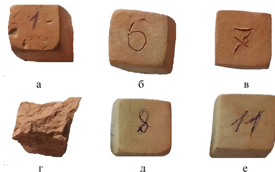
Образцы, обожженные в поле СВЧ из глин: а, б, в из гидрослюдистой глины, г, д, е из каолинистой глины с добавками б, д соли \text{NaCl} , в, е \text{Na}_2\text{CO}_3 .
