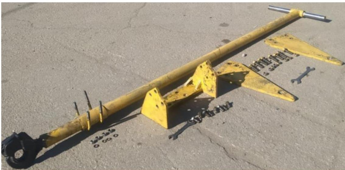
**Рисунок 1- Сборочные элементы буксирно-распределяющего устройства**
