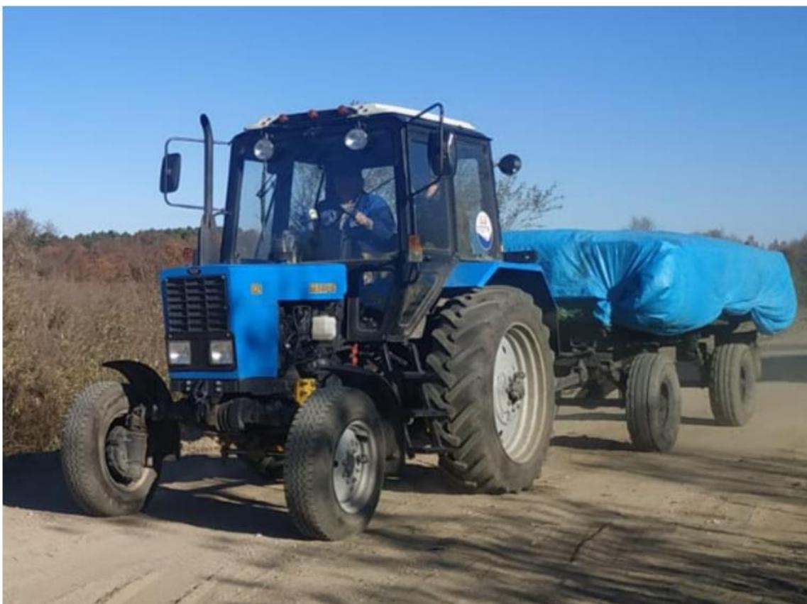
**Рисунок 2 –Фрагмент проведения экспериментальных исследований (опытный агрегат с установленным буксирно-распределяющим устройством)**
