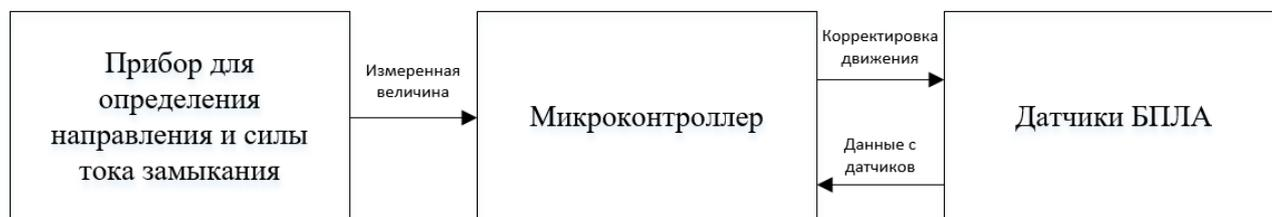
Рис. 1. Блок-схема элементов для объединения БПЛА и прибора для измерения направления и силы тока аварийного замыкания на землю
