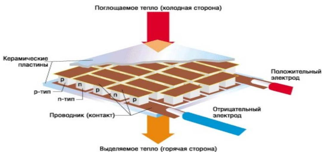
Рис.2. Схема термоэлектрического элемента Пельтье
