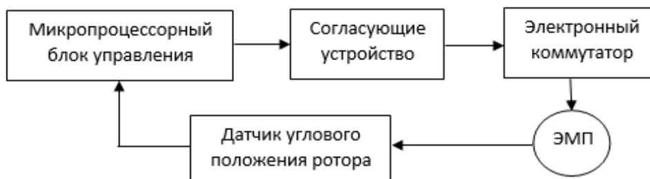
Рис. 1. Структурная схема управления реактивно-вентильным электродвигателем/генератором
