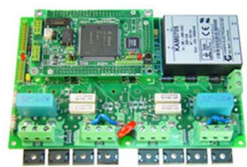
Рис. 2. Блок электроники для реактивно-вентильных электродвигателей / генераторов мощностью до 8 кВт
