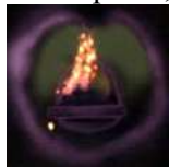
Рис. 2. Кадры высокоскоростной видеосъемки процесса горения модифицированных образцов твердого топлива, визуализирующие характерное образование микровзрывов
