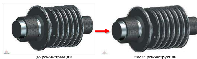
Рис. 6. Ротор ВД до и после реконструкции
