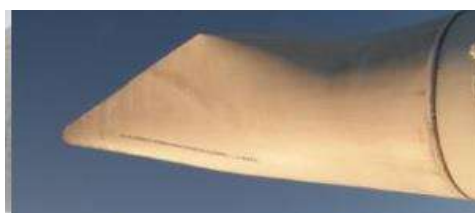
Рис. 2. Лопасть с защитным покрытием в условиях низких температур
