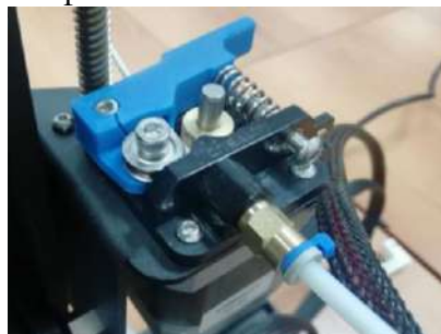
Рис. 2. Питатель со сломанным рычагом прижимного механизма
