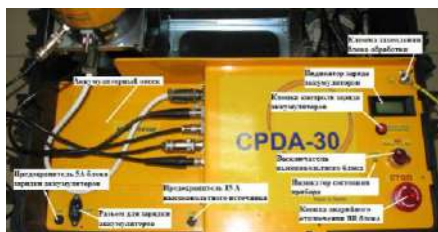
Рис. 1. Конструкция прибора CPDA-30
