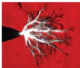
Рис. 1. Срез изоляции полиэтиленового кабеля с дендритом
