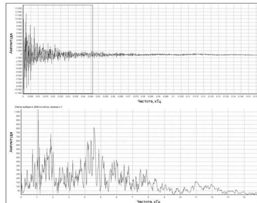
Рис. 7. Сигнал и спектр колебания пластины с отложением
