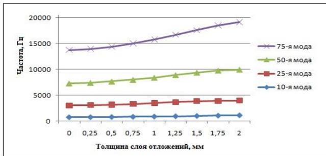
Рис. 3. Результат моделирования пластины с разными слоями отложений
