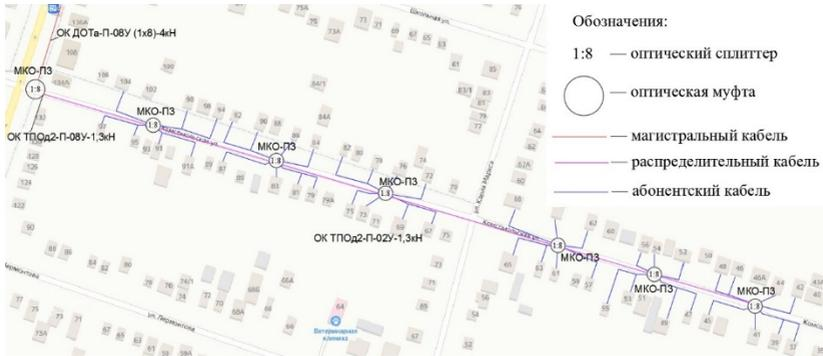
Рисунок 1 – Схема проектируемой сети GPON на выбранном участке
