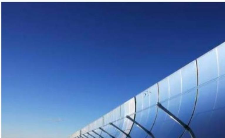
Рисунок 3- Параболическое зеркало
