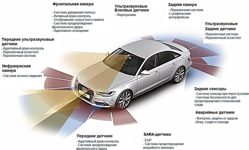
Рисунок 1 – Элементы, отвечающие за активную безопасность автомобиля
