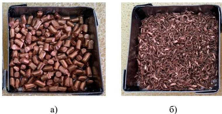
Рис. 2. Фотографии медных матриц с различными структурами в виде: (а) гранул; (б) стружки.
