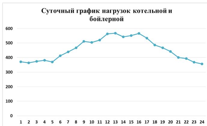
Рис. 2. Суточный график нагрузок котельной и бойлерной
