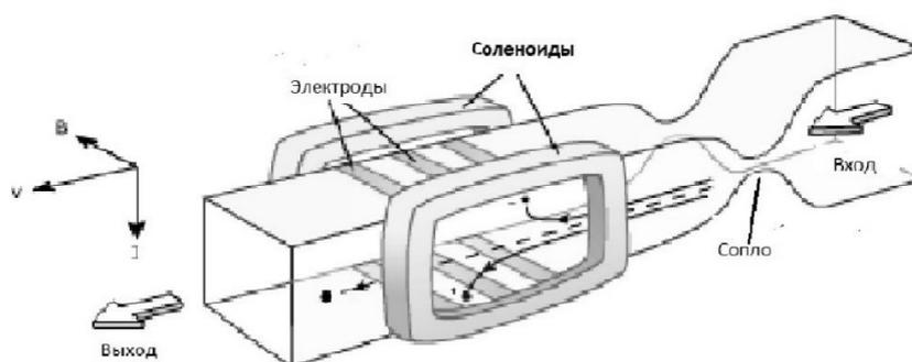
Рис. 1. Устройство МГД-генератора
